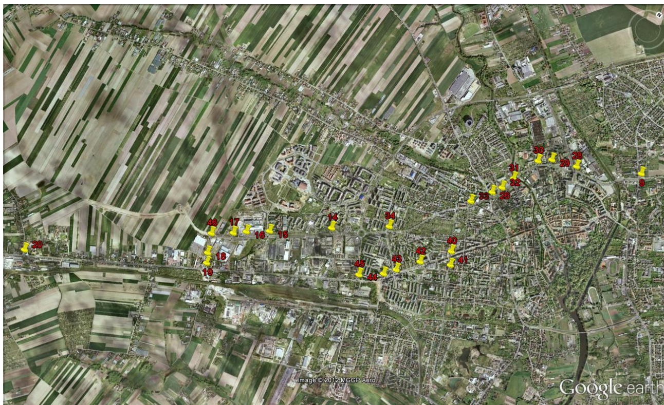
Rys. 5.0 Rozmieszczenie kamer na skrzyżowaniach – widok ogólny. Szczegółowe rozmieszczenie kamer zostało przedstawione w projekcie Docelowej Organizacji Ruchu
