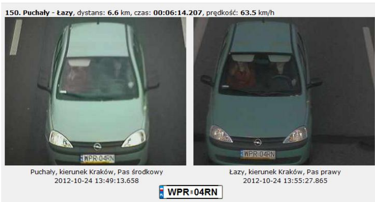
Rys. 9.1: Przykład pakietu danych z pomiaru prędkości odcinkowej ze zdjęciami pojazdów i sygnaturą czasową
